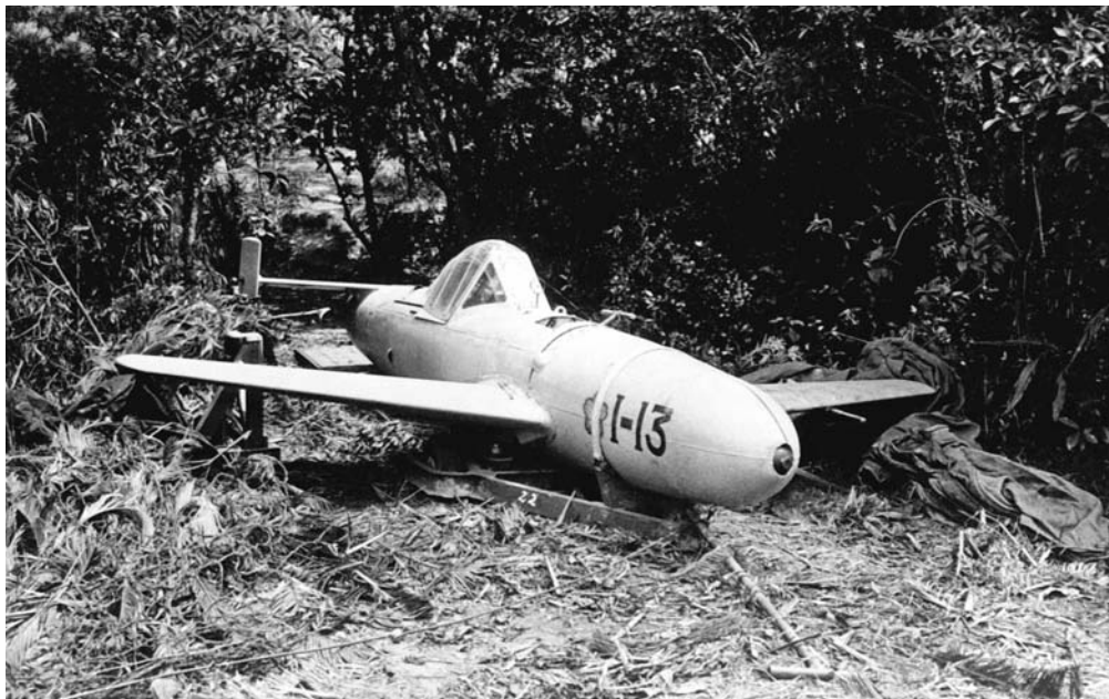
Пилотируемый летчиком-камикадзе реактивный самолет-снаряд
